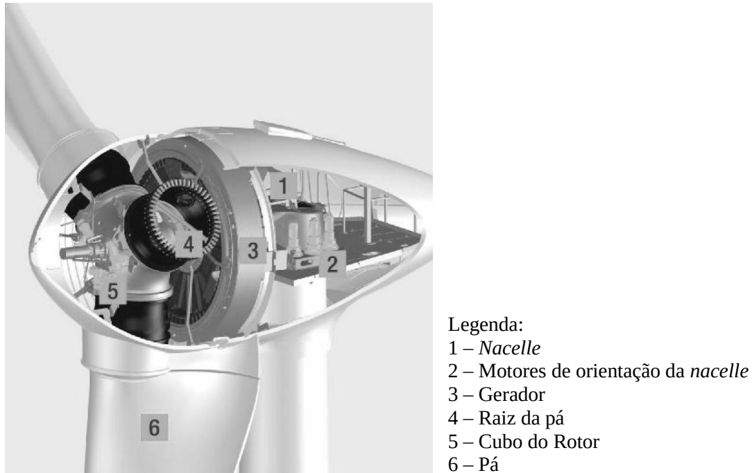
Figura 2.5 – Aerogerador sem caixa multiplicadora
