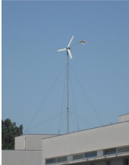
Figura 2.12 - Turbina com rotor de eixo horizontal
