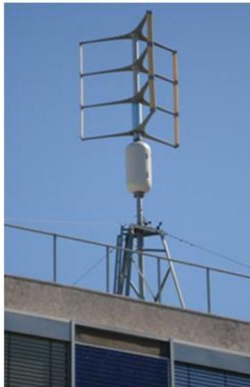
Figura 2.14 - Turbina com rotor de eixo vertical
